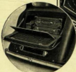
Coffre à bagages très spacieux. Compartiment insensé pour les outils aménagés dans le couvercle. Coffre indépendant pour la roue de secours. Eclairage électrique.
