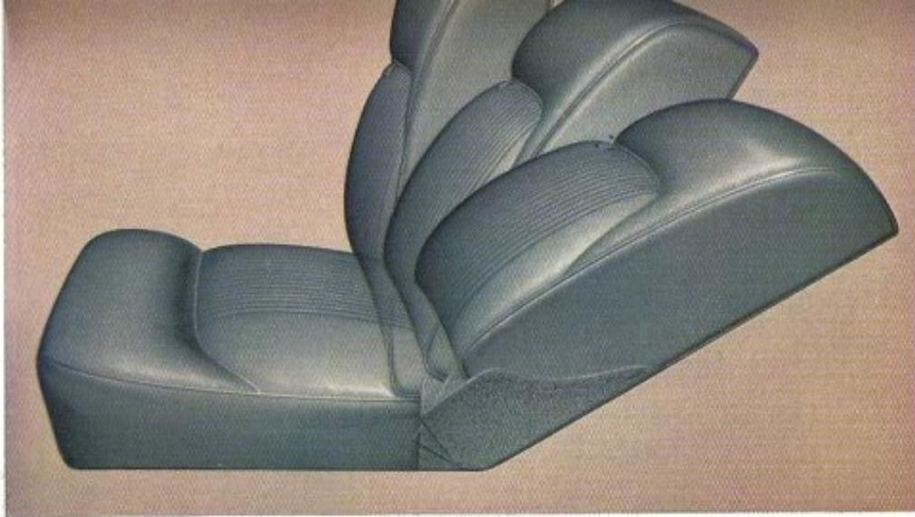
Des sièges avant à dossier réglable sont montés en série et comportent un système de réglage combiné vertical et longitudinal. On voit ici trois des positions que peut prendre le dossier.
