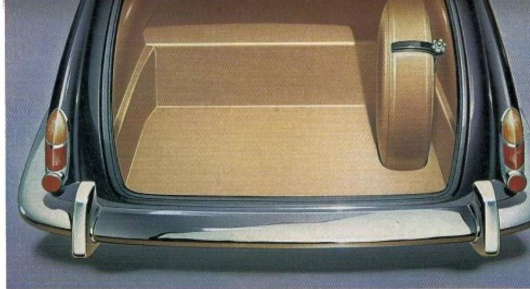
Le coffre à bagages a un volume de 0,764 m<sup>3</sup>, non comprise la place occupée par la roue de rechange et le coffre à outils. Ceux-ci peuvent être retirés sans déranger les bagages, dont la protection est assurée par la garniture du coffre et une housse recouvrant la roue de rechange.
